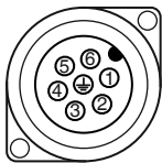
Распределение контактов в штекере X1
