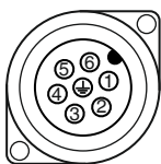
Распределение контактов в штекере X2
