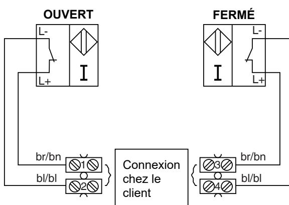
**Connexion électrique avec connecteur mâle M12 (code 1110)**
