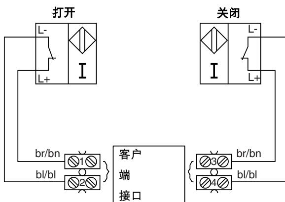
带M12插头的电气连接 (代码1110)
