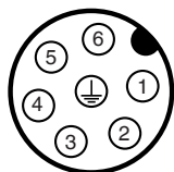
X 2: Соединительный штекер S1/S2 (беспотенциальный дополнительный концевой выключатель)
