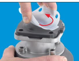
4. Absperrmembrane von der Ventilspindel / dem Druckstück abschrauben (Achtung: Rechtsgewinde, zum Lösen links herum drehen). Absperrmembrane sichten und gegebenenfalls Beschädigungen analysieren.
