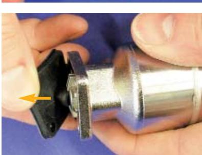
4. Осторожно, вращательным движением вытяните рукой запорную мембрану из нажимной детали. Проверьте запорную мембрану и проанализируйте повреждения, если они есть.
