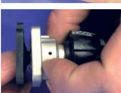
5. Вставьте новую запорную мембрану резиновым штифтом в нажимную деталь. Для этого нужно установить резиновый штифт на нажимной детали наискось и поворачивать запорную мембрану при вдавливании во все стороны. Не используйте вспомогательные смазочные материалы!
