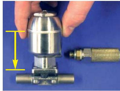
10. Установите клапаны в положение „закрыто“, клапаны с ручным управлением - только в положение „наполовину закрыто“.
