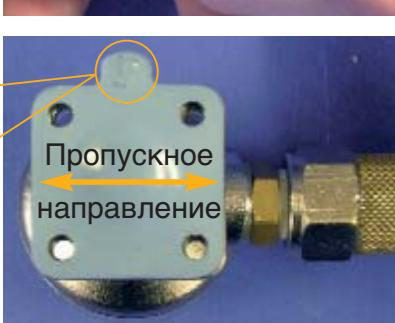
6. Выровните отверстия фланца запорной мембраны и привода клапана, чтобы они совпадали. Установите квадратную мембрану таким образом, чтобы информационная накладка находилась в одном направлении с уплотнительной перемычкой нажимной детали.
