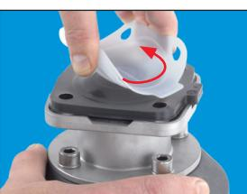
4. Desatornillar el diafragma de cierre del husillo de la válvula / del compresor (Atención: rosca a la derecha, girar a la izquierda para aflojar). Examinar el diafragma de cierre y, en caso necesario, analizar los daños.
