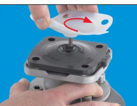
5. Atornillar el nuevo diafragma de cierre en el husillo de la válvula / el compresor hasta notar una clara resistencia. En diafragmas de cierre con 2 piezas, colocar la parte superior elastomérica exactamente sobre la brida del accionamiento de la válvula, insertar la placa de PTFE y proceder como se describe más arriba.
