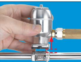
2. Aflojar en diagonal los tornillos que unen las bridas del cuerpo de la válvula, del diafragma y del accionamiento y tirar hacia arriba del accionamiento para separarlo del cuerpo de la válvula.
