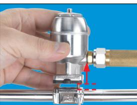
2. Allentare i bulloni del corpo valvola, membrana e attuatore diagonalmente e separare l'attuatore dal corpo valvola.
