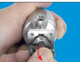
4. Tirare attentamente la membrana dal compressore, ruotandola manualmente. Controllare che la membrana non sia danneggiata.
