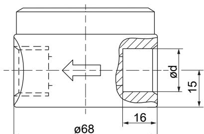
DN 10 :  $\varnothing d$  = 16DN 15 :  $\varnothing d$  = 20
