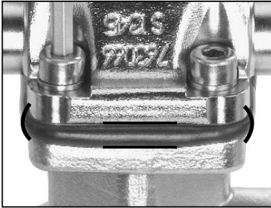
11. Verbindungsschrauben schrittweise über Kreuz mit geeignetem Werkzeug soweit festziehen, bis die Absperrmembrane ca. 10-15% ihrer ursprünglichen Dicke rundum gleichmäßig verpresst hat. Hat die Absperrmembrane rundum eine gleichmäßige Außenwölbung, ist die korrekte Verpressung erreicht.
