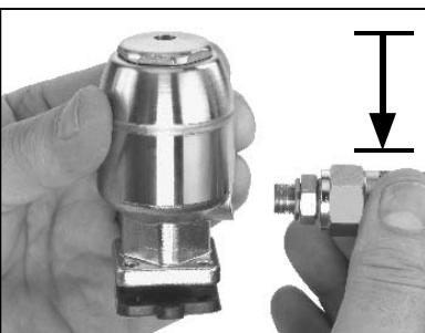
3. Ventilantrieb in Position „geschlossen“ bringen. Bei manuell betätigten Ventilanrieben darauf achten, dass sie nicht zu weit zgedreht werden und dadurch das Druckstück aus seinen seitlichen Führungen heraus läuft.
