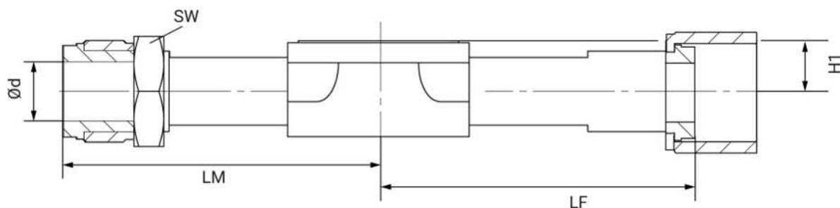
Anschlussart Überwurfmutter mit Innengewinde (Code FV)<sup>1)</sup>
