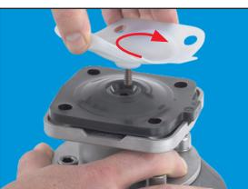
5. Avvitare la nuova membrana nel mandrino / compressore stringendo bene. Con le membrane 2 pezzi mettere la membrana di supporto sulla flangia dell'attuatore in modo da fissarla perfettamente. Invertire la parte PTFE facendo sporgere maggiormente il filetto.
