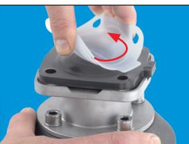
4. Svitare la membrana dal mandrino / compressore (attenzione: filettatura destrorso; girare in senso antiorario per pallentare). Controllare se la membrana è danneggiata.
