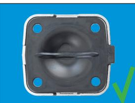
6. Girare la membrana (con la membrana 2 pezzi solo la parte PTFE) in senso antiorario fino a che i fori siano allineati ai bulloni (max 180°). Rimettere la parte PTFE nella sua forma originaria.
