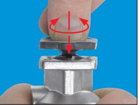
5. Neue Absperrmembrane mit Gummipin in das Druckstück einknüpfen. Dabei hilft es, den Gummipin am Druckstück schräg anzusetzen und die Absperrmembrane beim Eindrücken hin und her zu drehen. Keine Schmierhilfsstoffe verwenden!
