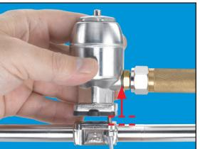
2. Verbindungsschrauben des Ventilkörper-, Membran- und Antriebsflansches über Kreuz lösen und Ventilantrieb vom Ventilkörper abheben.
