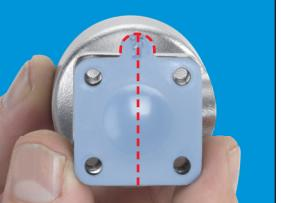
6. Flanschlöcher der Absperrmembrane und des Ventilantriebs in Übereinstimmung bringen. Die quadratische Membrane so ausrichten, dass die Informationslasche in Verlängerung zum Dichtsteg des Druckstücks steht.
