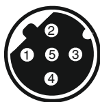
5-polige M12-Einbaudose, D-kodiert
