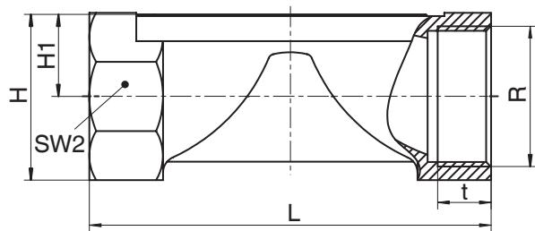
Anschlussart Gewindemuffe (Code 1)<sup>1)</sup>, Sphärogussmaterial (Code 90)<sup>2)</sup>
