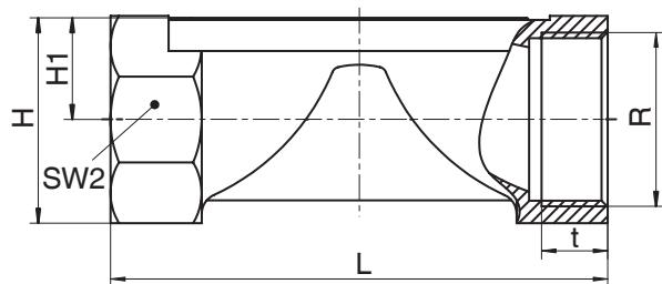
Вид соединения: резьбовая муфта (код 1)<sup>1)</sup>, чугун с шаровидным графитом (код 90)<sup>2)</sup>
