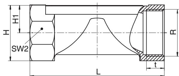
Вид соединения: резьбовая муфта NPT (код 31)<sup>1)</sup>, чугун с шаровидным графитом (код 90)<sup>2)</sup>
