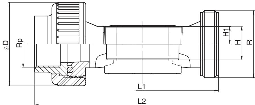
连接方式活接螺套Rp (代码7R)<sup>1)</sup>, 阀体材质PVC-U (代码1)<sup>2)</sup>
