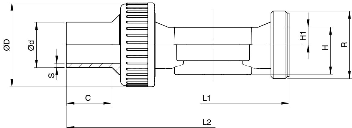
连接方式活接螺套DIN，红外对焊焊接（代码78）<sup>1)</sup>，阀体材质内胆/外壳（代码71、75）<sup>2)</sup>
