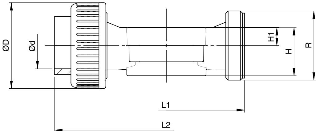
连接方式英制活接螺套 (代码33、3M、3T)<sup>1)</sup>, 阀体材质PVC-U (代码1)<sup>2)</sup>, 膜片尺寸MG 20 - 40
