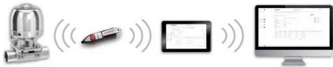
每个阀门和阀体、执行器和膜片等相关的阀门组件甚至是自动化组件都可以通过序列号进行明确追溯，并通过RFID读码器科莱索笔读取。可安装在移动终端设备上的科莱索应用程序简化并改进了“安装验证”过程，让维护过程更透明，能更好地进行记录。维护人员只需根据保养计划进行操作，并且可以直接访问工厂证书、检测文档和保养历史记录等与该阀门相关的信息。科莱索门户网站作为核心元素，可以汇总、管理和处理全部数据。
