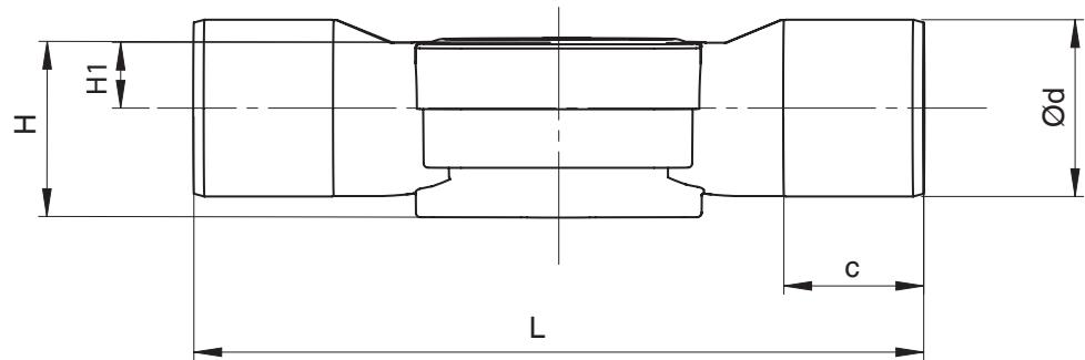
连接方式焊接DIN (代码0)<sup>1)</sup>, 阀体材质PVC-U (代码1)、PP (代码5)、PVDF (代码20)、内胆/外壳 (代码71、75)<sup>2)</sup>
