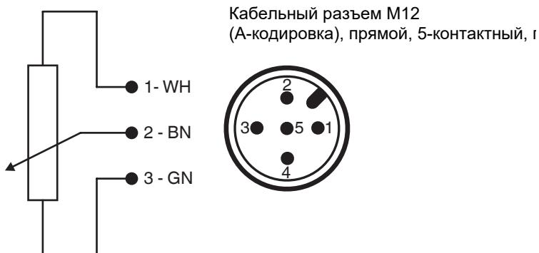
Данное исполнение пригодно для подключения к позиционерам GEMÜ 1434, 1436 или 1435 в исполнении с кабельным разъемом M12.
