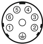
Распределение контактов в штекере X1, UV
