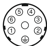
Распределение штекерных контактов S1/S2
