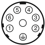
Распределение контактов в штекере X2, S1/S2
