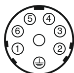
Распределение штекерных контактов UV
