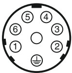
Распределение контактов в штекере X2, S1/S2
