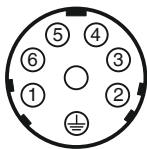
Распределение контактов в штекере X1, UV
