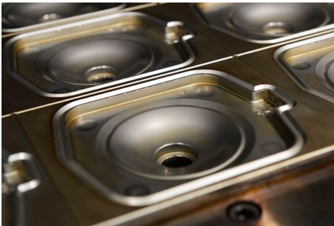
Abbildung 2: Werkzeugnester für die Herstellung von GEMÜ Membranen
