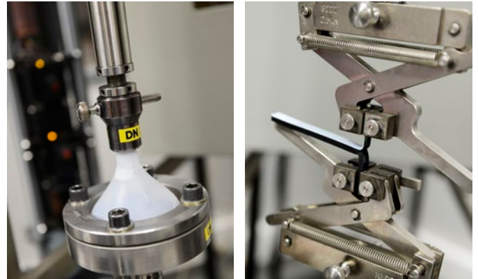
Abbildung 10: Überprüfung der Pin-Ausreißfestigkeit (links) und der Verbindung zwischen PTFE und EPDM (rechts)
