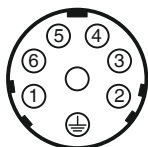
Распределение контактов в штекере X1, UV
