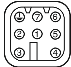
Распределение контактов в штекере X1
