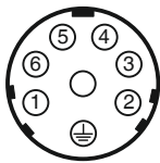
Распределение контактов в штекере X1, UV
