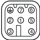
Распределение контактов в штекере X2
