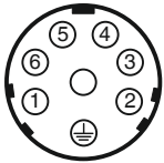
Распределение контактов в штекере X2, S1/S2
