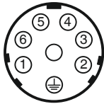
Распределение контактов в штекере X1, UV
