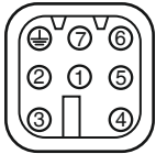
Распределение контактов в штекере X2
