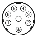
Распределение контактов в штекере X2, S1/S2
