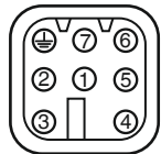
Распределение контактов в штекере X1
