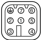
Распределение контактов в штекере X2
