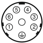
Распределение контактов в штекере X2, S1/S2
