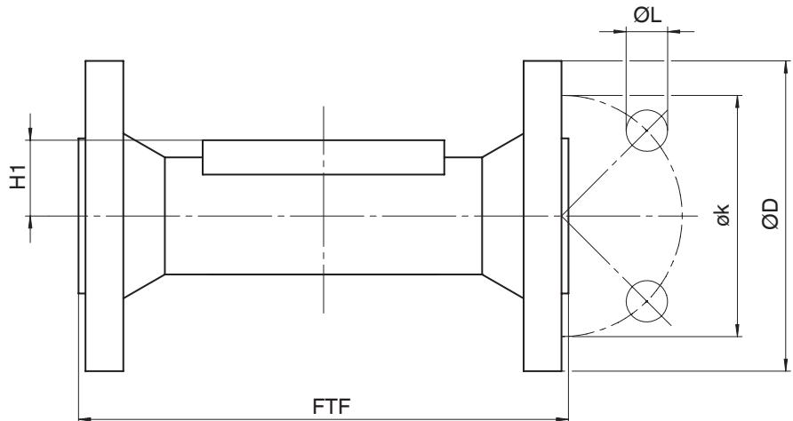
Вид соединения: фланец, монтажная длина согласно EN 558 (код 52)<sup>1)</sup>, серый литейный чугун (код 8), чугун с шаро-видным графитом (код 16, 92, 98)<sup>2)</sup>
