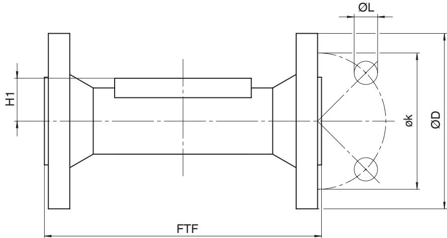
Вид соединения: фланец, монтажная длина согласно EN 558 (код 39)<sup>1)</sup>, чугун с шаровидным графитом (код 82, 83, 88)<sup>2)</sup>
