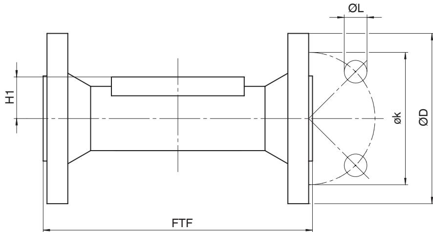
Вид соединения: фланец, монтажная длина согласно EN 558 (код 8)<sup>1)</sup>, чугун с шаровидным графитом (код 82, 83, 88)
