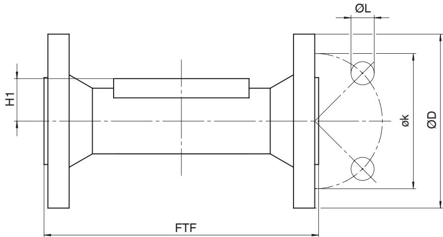
Вид соединения: фланец, монтажная длина согласно EN 558 (код 53)<sup>1)</sup>, серый литейный чугун (код 8), чугун с шаро-видным графитом (код 16, 92, 98)<sup>2)</sup>
