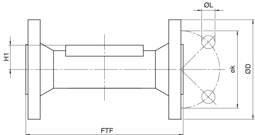
Вид соединения: фланец, монтажная длина согласно EN 558 (код 4)<sup>1)</sup>, чугун с шаровидным графитом (код 82, 83, 88)
