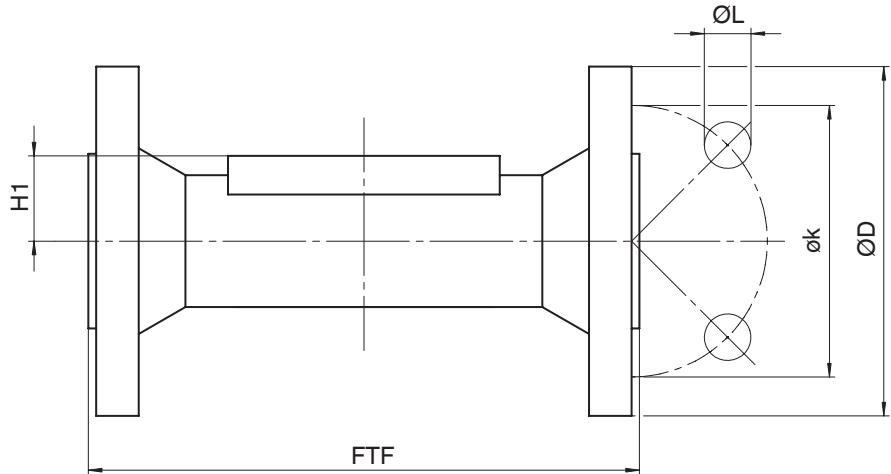
Вид соединения: фланец, монтажная длина согласно EN 558 (код 58)<sup>1)</sup>, серый литейный чугун (код 8), чугун с шаро-видным графитом (код 16, 92, 98)<sup>2)</sup>
