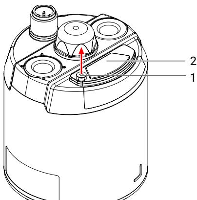
1. Schraube **1** (Innensechskant SW1,5) des Schieberdeckels **2** lösen (die Schraube ist durch einen Sicherungsring gegen Herausfallen aus dem Schieberdeckel **2** gesichert).
