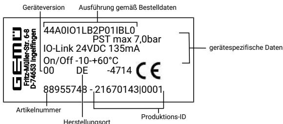
Das Herstellungsdatum ist unter der Produktions-ID verschlüsselt und kann bei GEMÜ erfragt werden.
