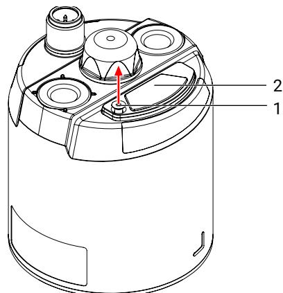
1. Schraube 1 (Innensechskant SW1,5) des Schieberdeckels 2 lösen (die Schraube ist durch einen Sicherungsring gegen Herausfallen aus dem Schieberdeckel 2 gesichert).
