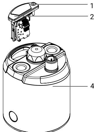
2. Schieberdeckel 2 mit Schraube 1 aus Gehäuse 4 entnehmen.
