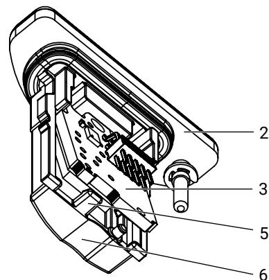
3. Schnapphaken 5 des Schieberdeckels 2 lösen und mit Zeigefinger das Bluetooth Modul Typ E1B0 3 durch die Griffmulde 6 aus dem Schieberdeckel 2 heben (**kein Werkzeug benutzen**, um Beschädigung zu vermeiden!).
