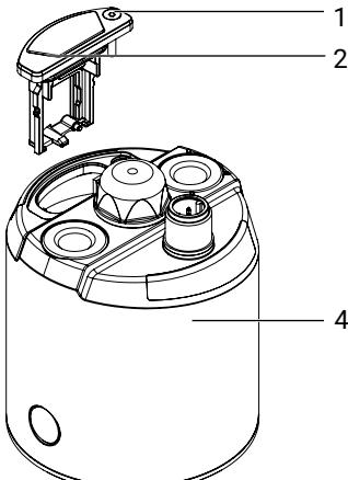
2. Schieberdeckel **2** mit Schraube **1** aus Gehäuse **4** entnehmen.
