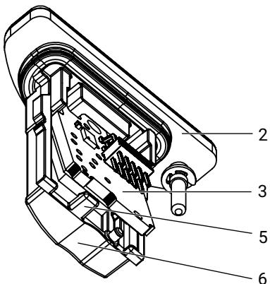
3. Enfoncer le module Bluetooth type E1B0 **3** dans le couvercle de tiroir **2** jusqu'à ce que le crochet de verrouillage **5** s'enclenche.
