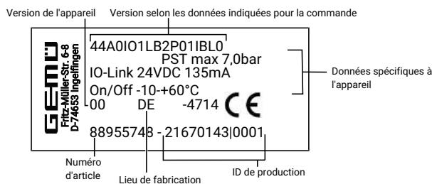
La date de fabrication apparaît sous forme cryptée dans l'ID de production et peut être demandée à GEMÜ.
