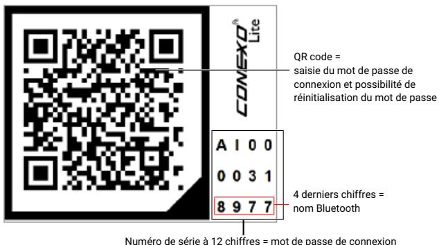
Le produit dispose d'une plaque signalétique digitale. La plaque signalétique digitale permet d'identifier sans confusion le produit à travers le monde et de consulter, outre les données classiques de la plaque signalétique, d'autres informations digitales relatives au produit.
