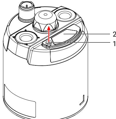
1. Desserrer la vis 1 (six-pans intérieur d'ouv. 1,5) du couvercle de tiroir 2 (une rondelle de sécurité bloque la vis pour l'empêcher de tomber du couvercle de tiroir 2).
