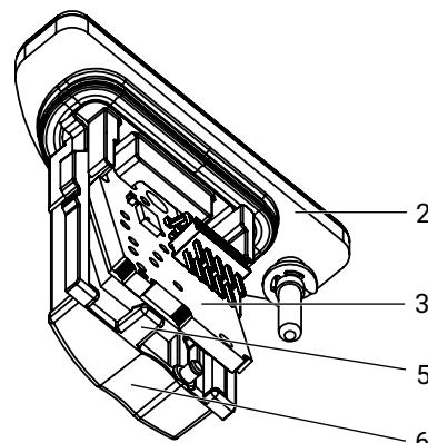
3. Desserrer le crochet de verrouillage 5 du couvercle de tiroir 2 et faire levier de l'index sur le module Bluetooth type E1B0 3 par la poignée encastrée 6 pour l'extraire du couvercle de tiroir 2 (**ne pas utiliser d'outil** afin d'éviter tout dommage !).
