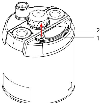
1. Desserrer la vis 1 (six-pans intérieur d'ouv. 1,5) du couvercle de tiroir 2 (une rondelle de sécurité bloque la vis pour l'empêcher de tomber du couvercle de tiroir 2).
