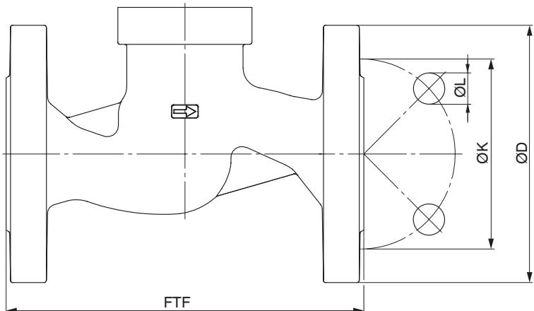
Type de raccordement bride, encombrement EN 558 (code 39)<sup>1)</sup>, inox de fonderie (code 37), fonte sphéroïdale (code 90)<sup>2)</sup>
