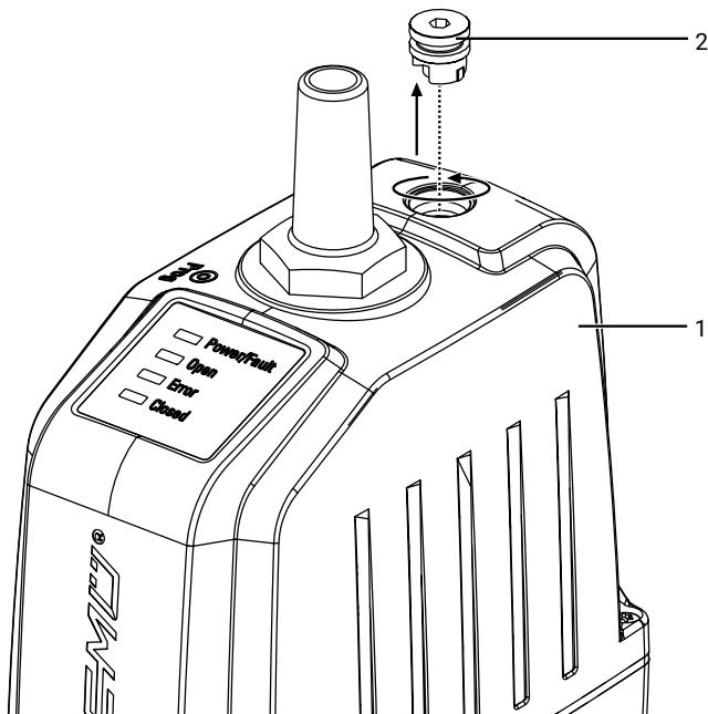
1. Dévisser le bouchon 2 du couvercle 1 dans le sens contraire des aiguilles d'une montre et le retirer.
