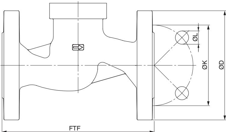
Type de raccordement bride, encombrement EN 558 (code 10)<sup>1)</sup>, inox de fonderie (code 37)<sup>2)</sup>
