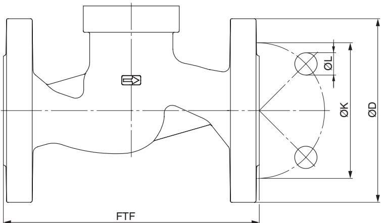
Type de raccordement bride, encombrement EN 558 (code 8)<sup>1)</sup>, fonte sphéroïdale (code 90)<sup>2)</sup>
