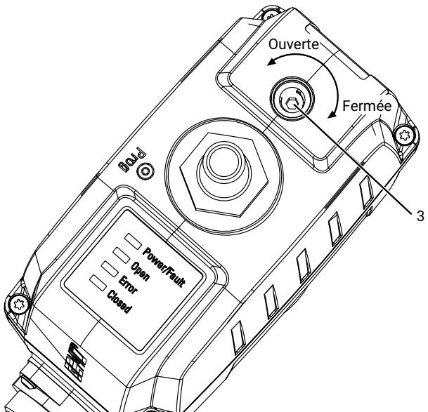
2. Actionner la commande manuelle de secours 3 avec une clé Allen (ouv. de 3 mm).
