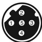
5-polige M12-Einbaudose, D-kodiert
