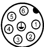
X2: Connecteur à fiches S1/S2 (potentiomètre rotatif comme retour de valeur actuelle)
