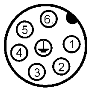
X2: Connecteur à fiches S1/S2 (fin de course isolé supplémentaire)
