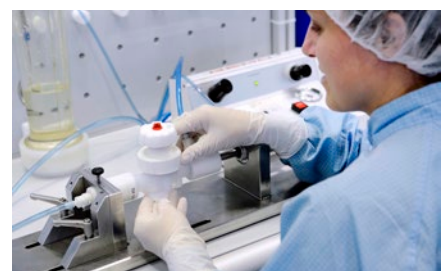
Montage im Reinraum und 100 % Prüfung (Dichtigkeit etc.)
