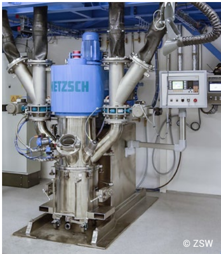
Produktionsforschung am ZSW: 60l-Mischanlage für Elektrodenpasten. Bild: ZSW
