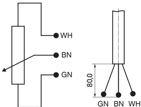
Diese Ausführung ist geeignet für den Anschluss an den Stellungsregler GEMÜ 1435 (außer GEMÜ 1435 Ausführung mit M12-Kabelstecker).
