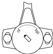
Der Arbeitsbereich befindet sich auf der Seite des Kabelabgangs.
