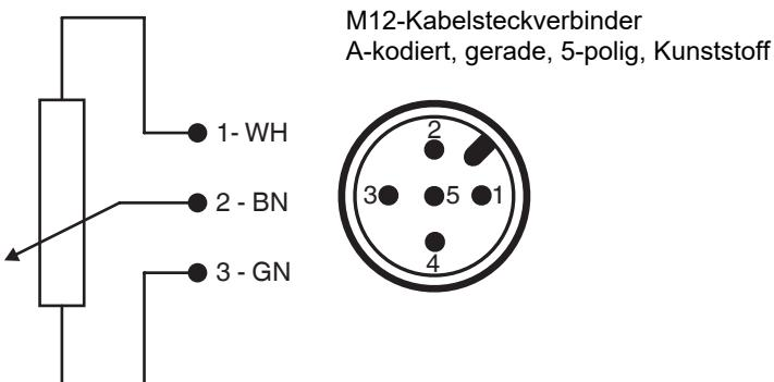
Diese Ausführung ist geeignet für den Anschluss an den Stellungsregler GEMÜ 1435, 1436 oder 1441 mit der Ausführung M12-Kabelsteckverbinder.
