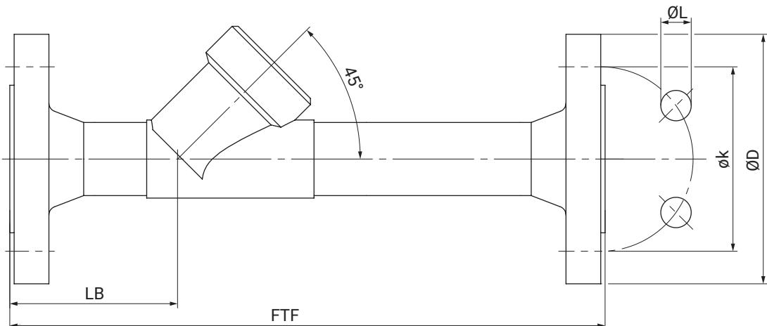
连接方式 : 法兰特殊结构长度EN/ANSI ( 代码13、47 )<sup>1)</sup>, 精密铸造材料 ( 代码34 )<sup>2)</sup>
