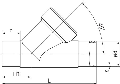
连接方式：焊接DIN/EN/ISO (代码0、16、17、60)<sup>1)</sup>, 精密铸造材料 (代码34)<sup>2)</sup>
