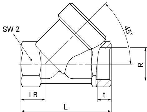
连接方式：内螺纹（代码1）<sup>1)</sup>，精密铸造材料（代码37）<sup>2)</sup>
