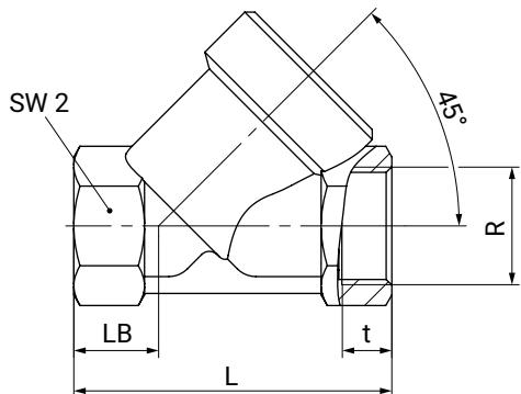
连接方式：内螺纹DIN/NPT (代码1)<sup>1)</sup>，整体加工 (代码9)<sup>2)</sup>
