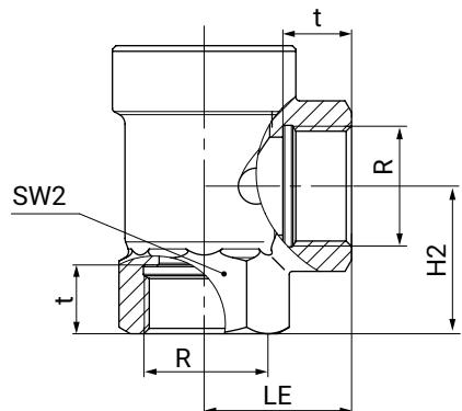
连接方式：内螺纹DIN/NPT (代码1、3D)<sup>1)</sup>, 精密铸造材料 (代码37)<sup>2)</sup>
