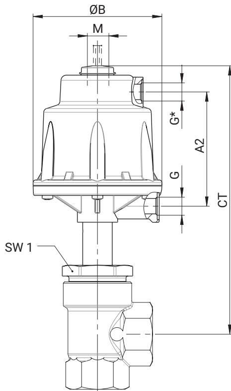
\* 该连接仅适用于执行器尺寸1和2；控制方式2和3
