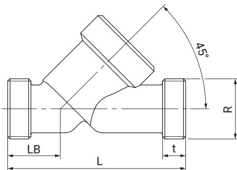
连接方式 : 内螺纹DIN (代码9)<sup>1)</sup>, 精密铸造材料 (代码37)<sup>2)</sup>
