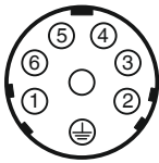
Steckerbelegung X2, S1/S2
