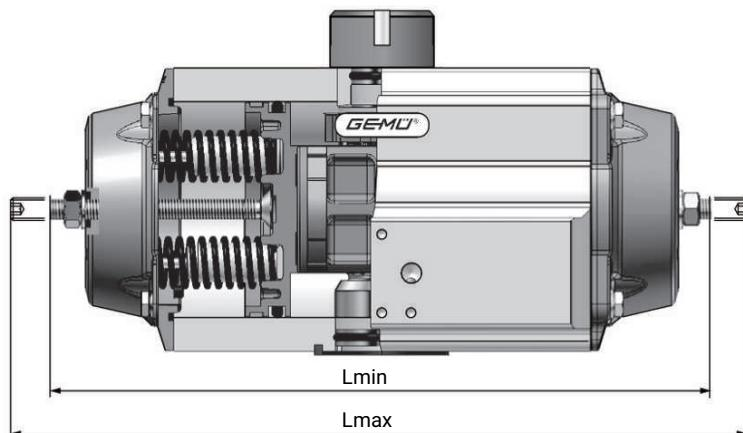
Actionneur avec possibilité de réglage de fin de course en fonction de l'angle de rotation (100 %)
