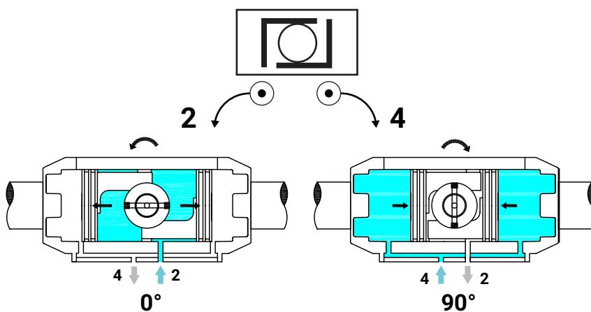
Les pistons sortent sous l'effet de l'air au niveau du raccord « 2 », ce qui fait tourner l'axe dans le sens contraire des aiguilles d'une montre alors que l'air est évacué par le raccord « 4 ». Les pistons rentrent sous l'effet de l'air au niveau du raccord « 4 », ce qui fait tourner l'axe dans le sens des aiguilles d'une montre alors que l'air est évacué par le raccord « 2 ».
