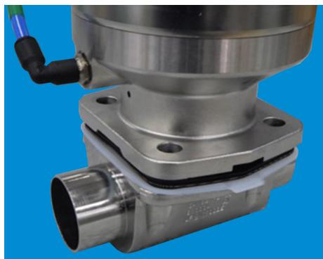
1. Disposer l'actionneur avec la membrane en place sur le corps de vanne.
