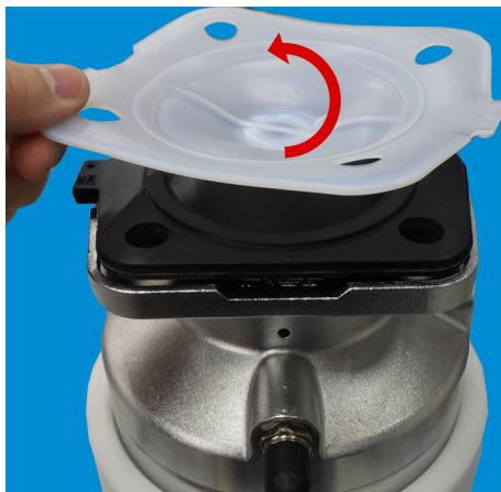
1. Inverser à la main la feuille PTFE et la dévisser de l'axe de la vanne/du sabot (filetage à droite : tourner vers la gauche pour desserrer).
