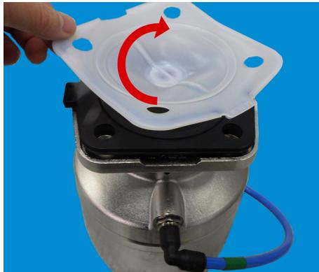
1. Disposer précisément la membrane d'appui EPDM sur la bride de l'actionneur.
