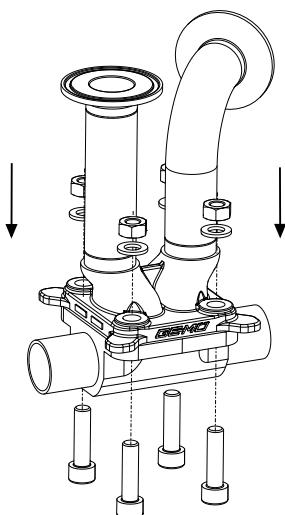
1. Установить многофункциональный адаптер PPF на корпус клапана.
