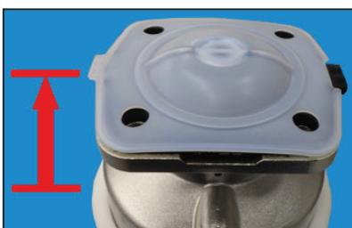
4. PTFE-Membranschild von Hand umstülpen und von der Ventilspindel / dem Druckstück abschrauben (Rechtsgewinde: zum Lösen links herumdrehen).
