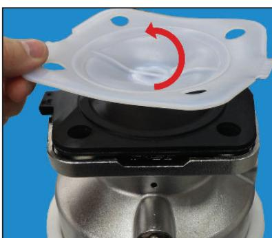
7. Neue EPDM-Stützmembrane lagerichtig auf den Antriebsflansch legen.
