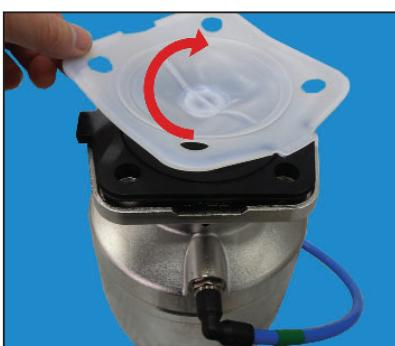
9. PTFE-Membranschild bis zur nächstmöglichen Übereinstimmung des Lochbildes zurückdrehen (max. 180°).
