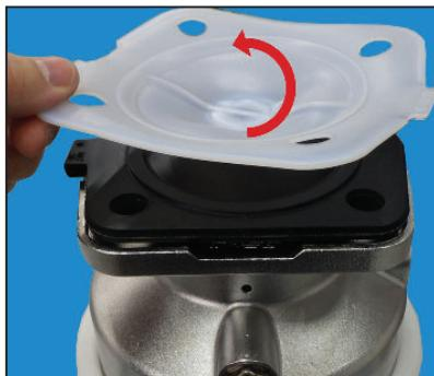
4. Dar la vuelta con la mano a la lámina del diafragma PTFE y desenroscarla del eje de la válvula/del compresor (rosca a derecha: girar hacia la izquierda para aflojar).
