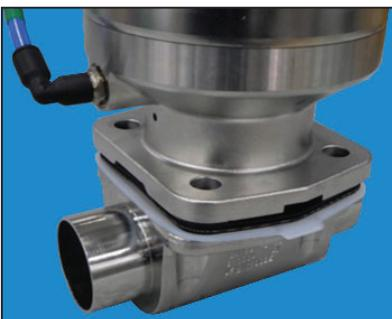
12. Colocar el actuador en el cuerpo de la válvula con el diafragma montado.
