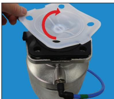
7. Colocar correctamente el nuevo diafragma de apoyo EPDM en la brida del actuador.
