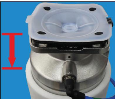
11. Colocar el actuador en la posición abierta.
