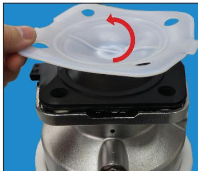
4. Retourner à la main la feuille PTFE et la dévisser de l'axe de la vanne/du sabot (filetage à droite : tourner vers la gauche pour desserrer).
