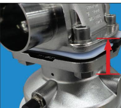
**15.** Mettre les actionneurs pneumatiques en position de fermeture (mettre les actionneurs à commande manuelle seulement en position « à moitié fermée » et ouvrir d'environ 20 % les actionneurs à commande électrique).
