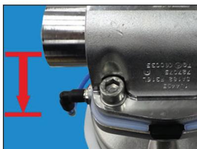
1. Mettre l'actionneur en position d'ouverture.
