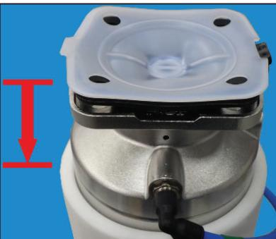
**11.** Mettre l'actionneur en position d'ouverture.
