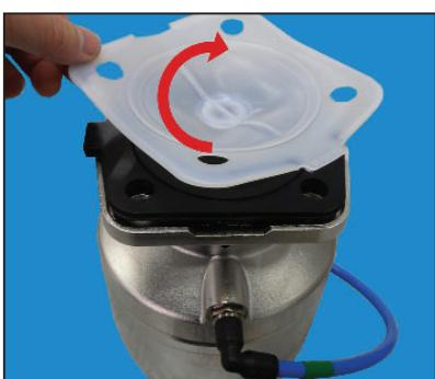
9. Ruotare il foglio di teflon in PTFE fino a far coincidere il più possibile i fori di fissaggio (max 180°).
