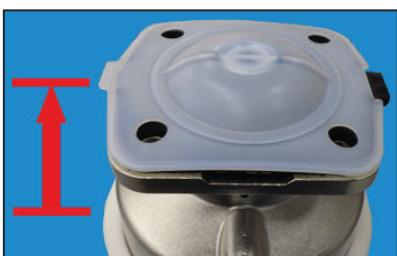
4. Capovolgere manualmente il foglio di teflon in PTFE e svitarlo dallo stelo della valvola / dal compressore (filettatura destrorsa: ruotare in senso antiorario per allentarla).
