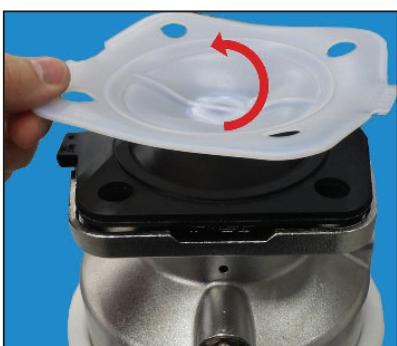
7. Posizionare correttamente la nuova membrana di sostegno in EPDM sulla flangia di azionamento.
