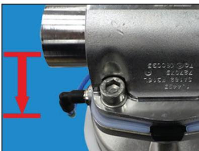
2. Soltar os parafusos em cruz e levantar o atuador do corpo da válvula.
