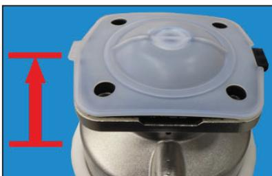
4. Virar manualmente a película do diafragma PTFE de cabeça para baixo, e desaparafusar da haste da válvula / do compressor (rosca direita: para solta, rodar para a esquerda).
