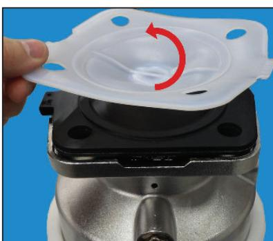
7. Colocar um novo diafragma de apoio EPDM na devida posição sobre o flange de atuador.
