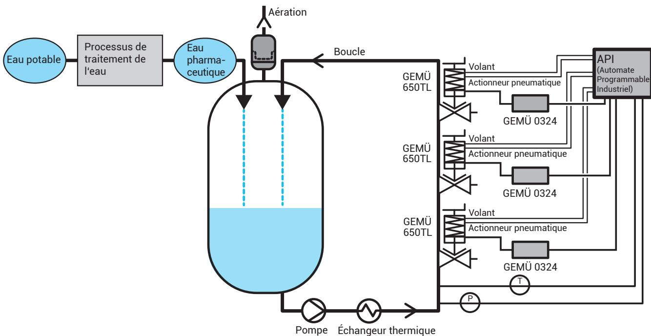
Le volant se trouve alors toujours en position ouverte et doit être placé manuellement en position fermée en le tournant dans le sens des aiguilles d'une montre. Toute fuite incontrôlée du fluide aux points de prélèvement est ainsi évitée lorsque la vanne est de nouveau pressurisée.
