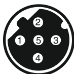
5-polige M12-Einbaudose, D-kodiert
