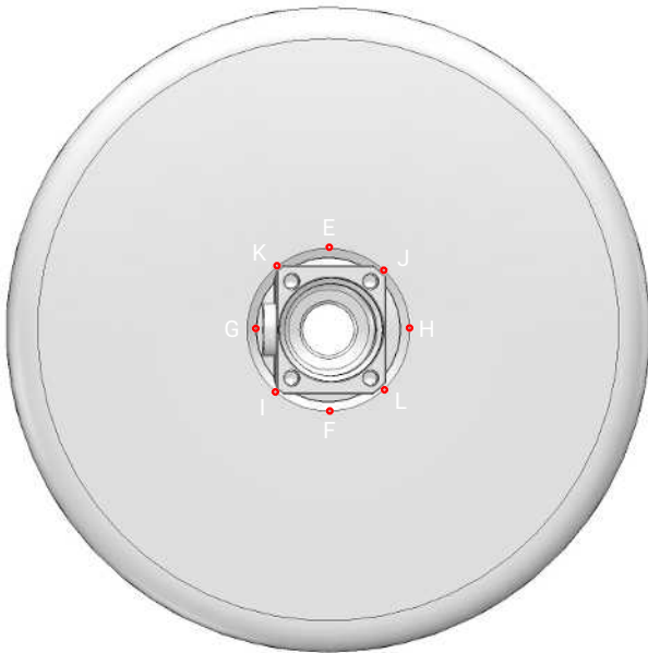
Vue de l'extérieur de la cuve avec les points de pointage
