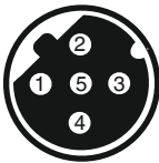
5-polige M12-Einbaudose, D-kodiert
