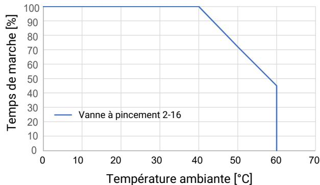
Module de régulation - Positionneur (code S0, S5, S6), fonctions de régulation - Classe C selon EN 15714-2 jusqu'à 60 °C de température ambiante
