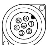
7-контактный штекер фирмы Binder, тип 693
