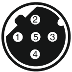
5-polige M12-Einbaudose, D-kodiert
