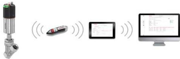
每个阀门和阀体、执行器等相关的阀门组件甚~是自动化组件都可以通过序列号进行明确追溯，并通过RFID读码器科莱索笔读取。可安装在移动终端设备上的科莱索应用程序简化并改进了“安装验证”过程，让维护过程更透明，能更好地进行记录。维护人员只需根据保养计划进行操作，并且可以直接访问工厂证书、检测文档和保养历史记录等与该阀门相关的信息。科莱索门户网站作为核心元素，可以汇总、管理和处理全部数据。
