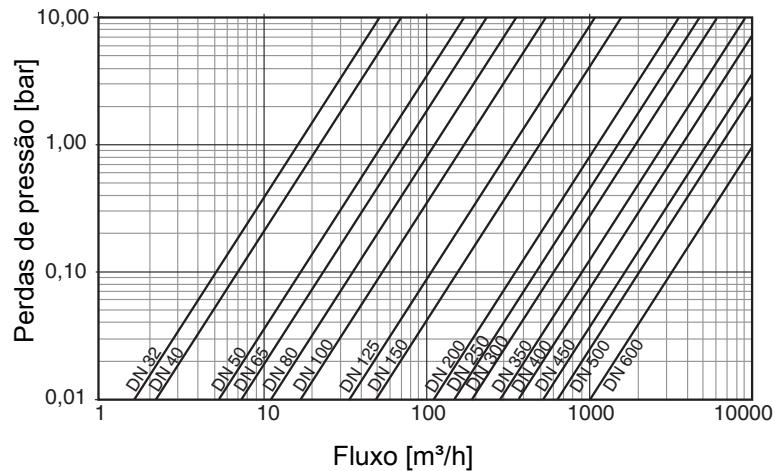
Os valores do diagrama valem para água a uma temperatura de 20° C.
